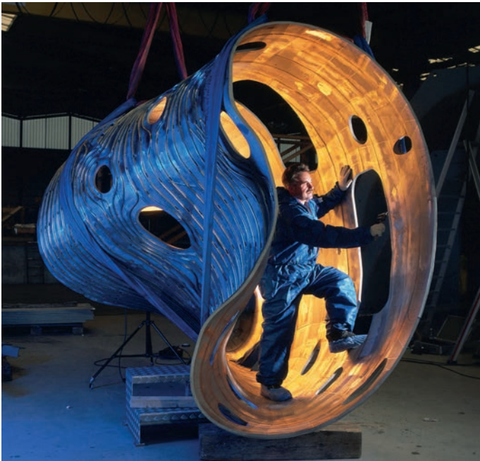
In der manngrößen Röhre des Plasmagefäßes bildet sich später das Plasma aus.
