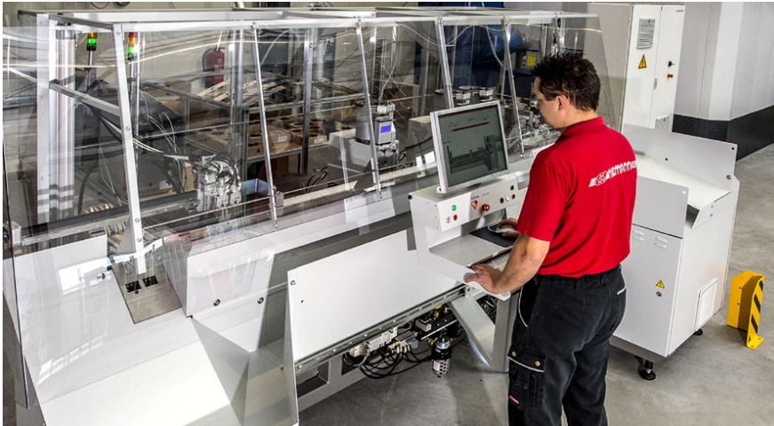
Für die Herstellung der Drähte und Drahtsätze hat die NW-Niemann GmbH in ein NC-Bearbeitungszentrum von Komax investiert – die Daten dafür kommen direkt aus dem mit der WSCAD SUITE erstellten Schrankaufbau.
